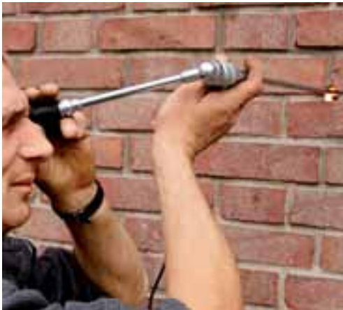
Kontrolle der Luftschicht mit dem Endoskop
