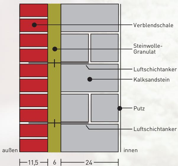
Am Beispiel eines schematischen Wand-Querschnitts lässt sich leicht nachvollziehen, wie genial einfach, sicher und zugleich effizient die nachträgliche Hohlräumdämmung ist.
